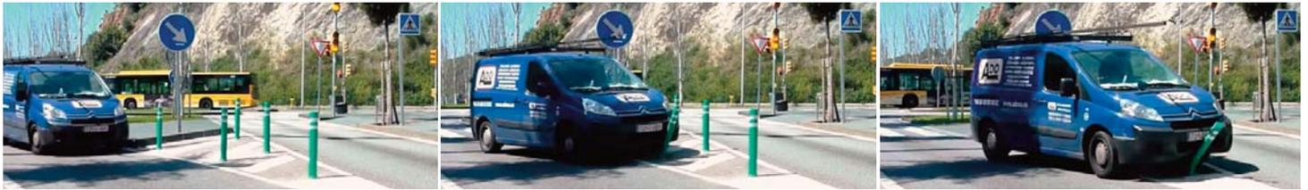
Le proprietà di questo materiale permettono che in caso di impatto, il dissuasore torni alla sua forma e posizione originale. Non si rompono, non si deformano, non si ossidano.
