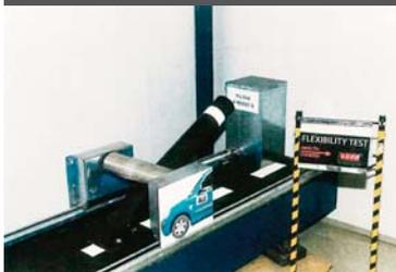
Plus de 6000 cycles de flexion ont été réalisés sans qu'aucune fente n'apparaisse sur la surface de la borne et au cours desquelles le potelet est retourné à sa position d'origine après que la force nécessaire pour le fléchir à 90° soit appliquée
