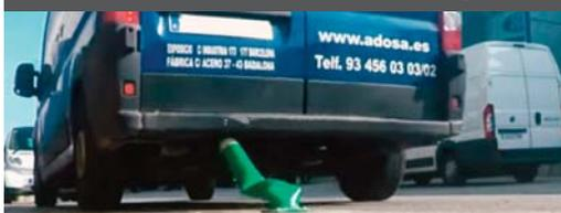
Impact d'un véhicule à plus de 80 km /h contre la borne A-Resist sans qu'elle ne soit endommagée.
