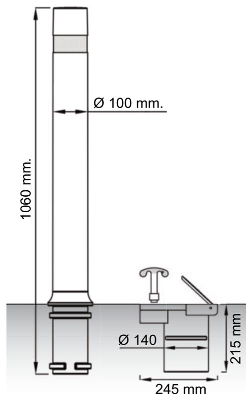
Base en plastique amovible de couleur noire avec couvercle supérieur rabattable. Dispose d'une clé triangulaire standard située sur le côté de la base pour verrouiller le couvercle une fois fermé ou pour verrouiller la borne une fois insérée dans le trou.
